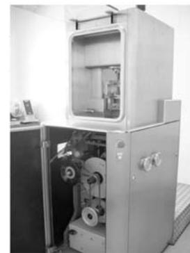
Equipé de capteurs de forces et de déplacements, le simulateur de compression permet en particulier aux chercheurs et industriels :
